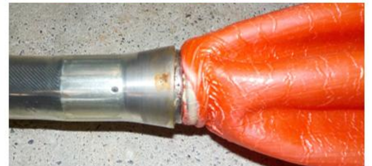
Foto's: gaslek en losgekomen aansluiting bij inspectie
