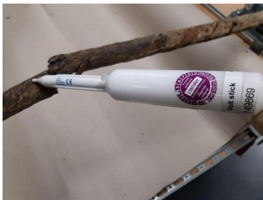
onjuiste locatie voor meten met voltestick
