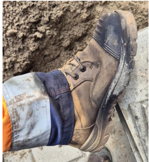
Foto: Veiligheidsschoen van de door vlamboog getroffen medewerker.
