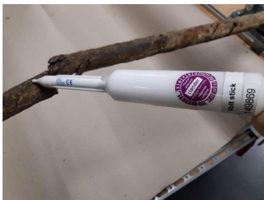
onjuiste locatie voor meten met voltstick
