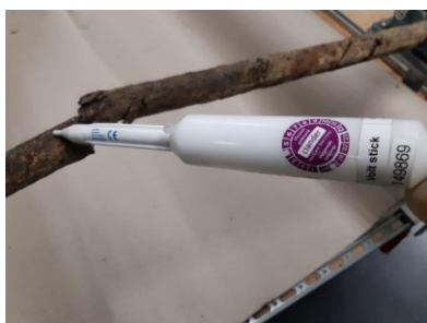
onjuiste locatie voor meten met voltestick
