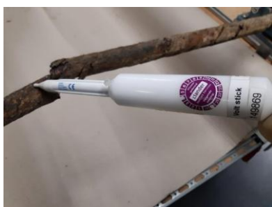
onjuiste locatie voor meten met voltestick
