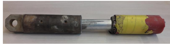
Foto 2: kabeluiteinde 1x630 Al met losgeschoten trekkop
