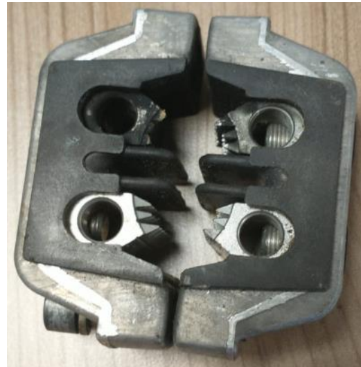
Foto: ringklem van een aftakmof na kortsluiting
