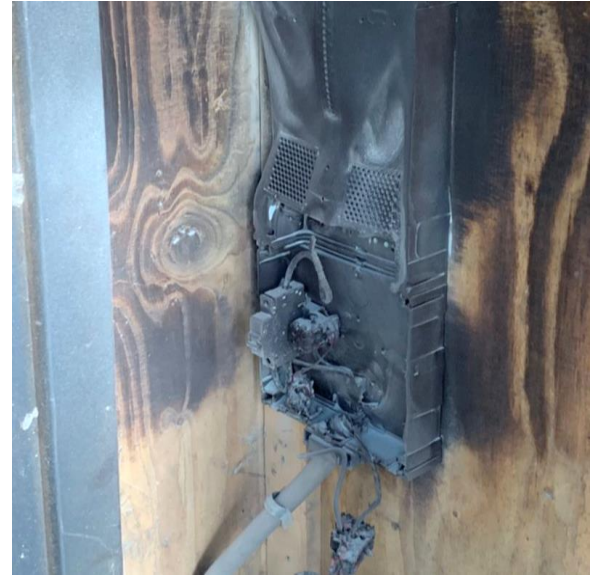
Foto: verbrande meterkast na incident
