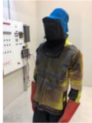
Foto 1: vlamboog op dummy na test (DEKRA)
