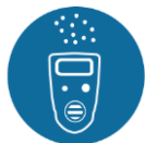
Gassignaleringsapparatuur met akoestisch en optisch signaal
